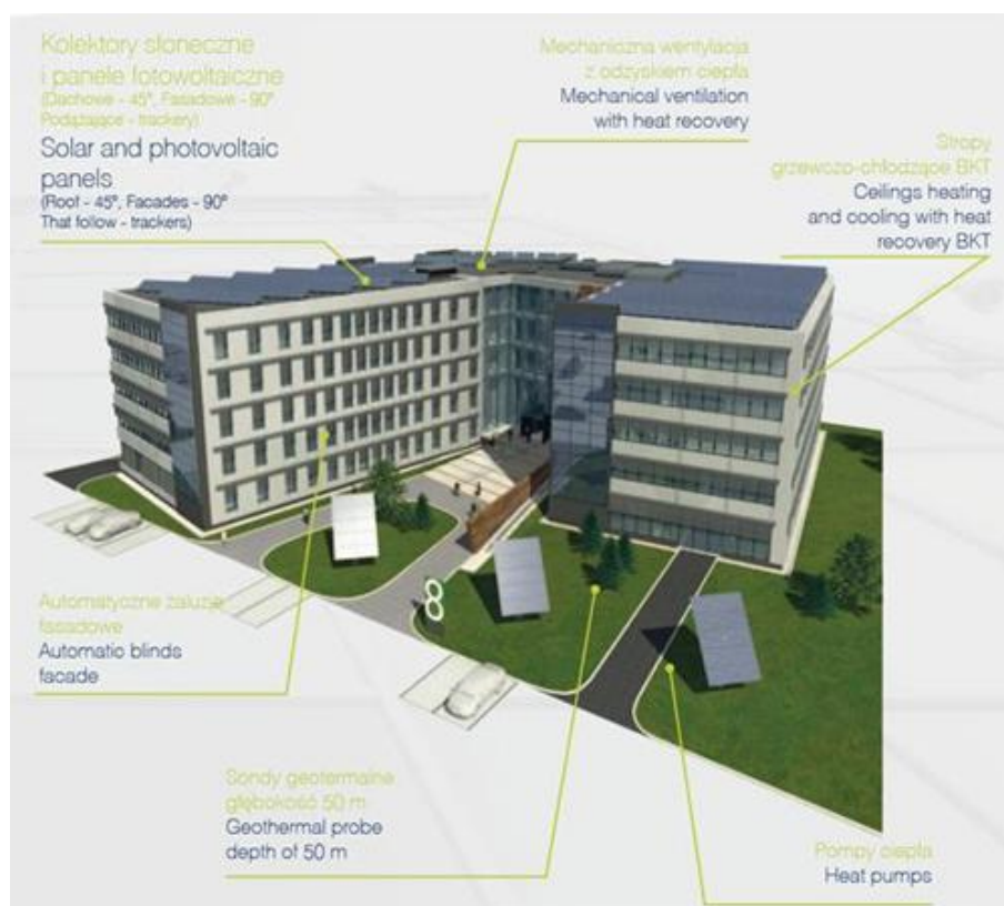
Prezentacja systemów zastosowanych w pasywnym budynku (fot. Euro-Centrum Park Naukowo-Technologiczny)
