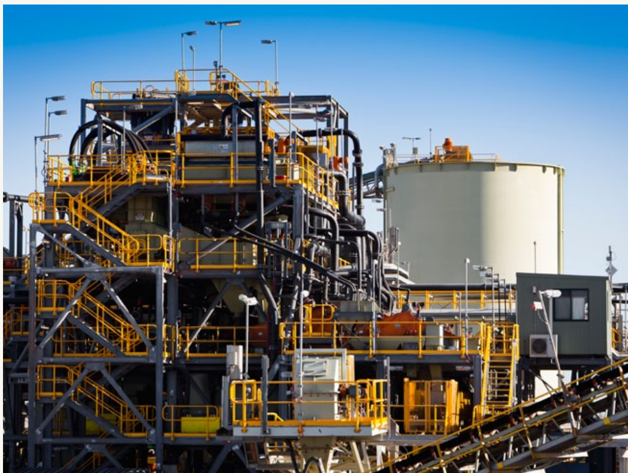
Obróbka mechaniczna wykorzystywana do rafinowania koncentratu spodumenu litu w zachodniej Australii. Lit jest stosowany do produkcji baterii o wysokiej gęstości.
