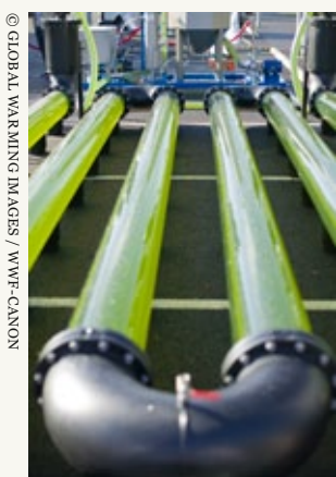
AlgaeLink. System uprawy alg, które są pozyskiwane w celu wytwarzania etanolu i biodiesla w Wielkiej Brytanii. Produkcja oleju z alg w taki właśnie sposób jest o wiele bardziej efektywna niż w przypadku uprawy tradycyjnych roślin oleistych, takich jak olej rzepakowy. Dodatkową zaletą jest oszczędność miejsca w porównaniu z uprawą roślin spożywczych.
